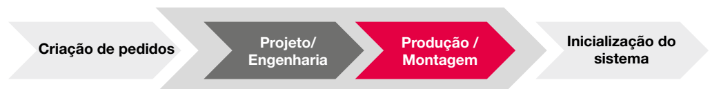
Figure 1.1: As fases estudadas na fabricação do painel de controle. A criação de pedidos e a inicialização do painel de controle / sistema de máquina não estão incluídas neste estudo.
